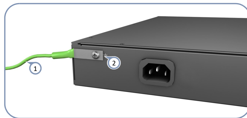
Figura 16: Terminal de Aterramento
