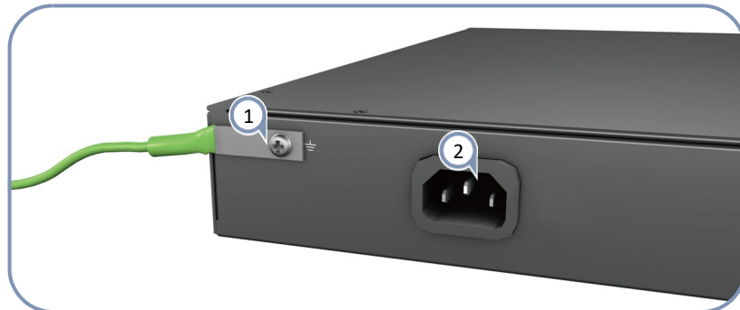
Figura 4: Conectando Alimentação AC
