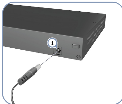
Figura 5: Conectando Alimentação DC
